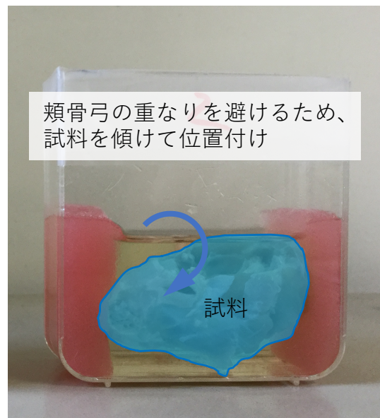
図 3.7 試料の固定方法と実際の固定の例
