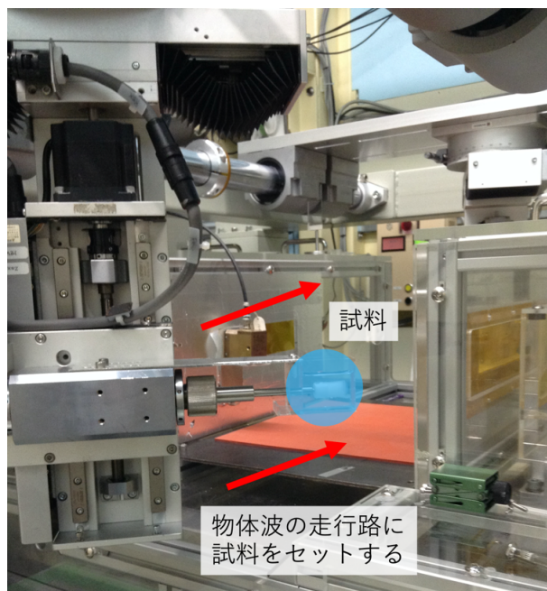
図 4.6 結晶干渉計への実際の試料の設置
