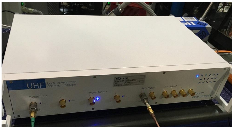
図 1-10 本研究で採用した UHF-デジタルロックインアンプ (Zurich Instrument)。参照信号によってノイズに埋もれた特定周波数帯の信号を復調することができる装置である。
