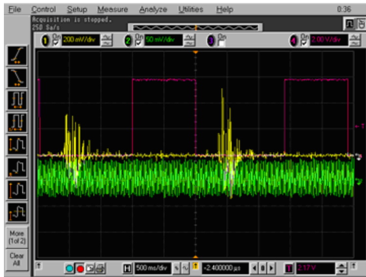
図 5.9: エネルギースキャン中の I0 信号 (ch1:黄) とゲート信号 (ch4 : 赤紫) の波形。ch2 : 緑は HV アンプに与えている周期的駆動電圧である。
