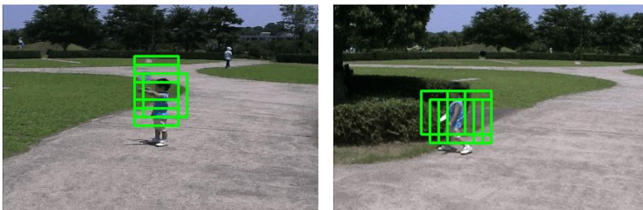
図 3-33 携帯ビデオカメラで撮影した画像からの移動体候補の検出結果例
